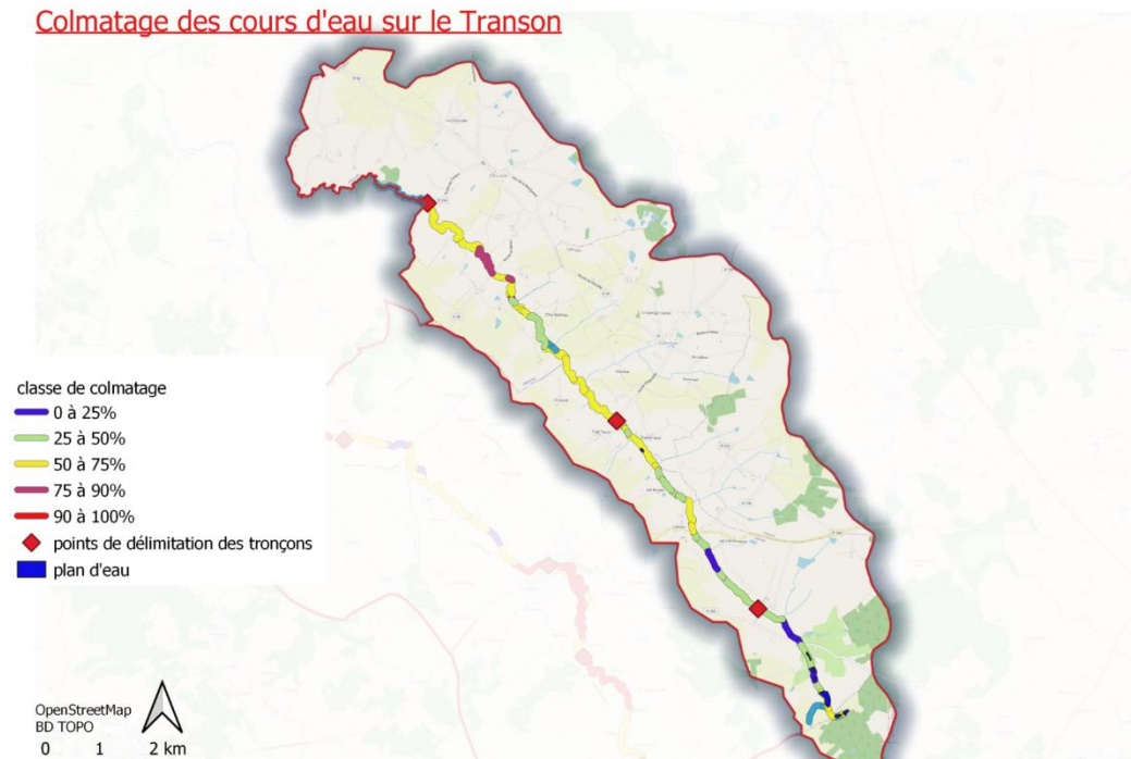
Figure 34: Colmatage des cours d'eau sur le Transon
